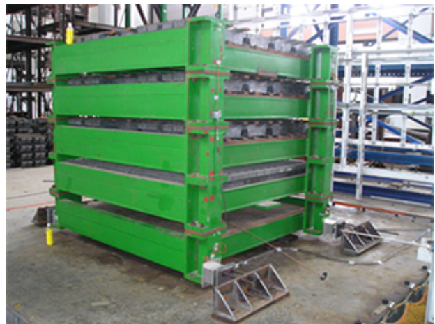
圖五、足尺寸振動台試驗裝置
