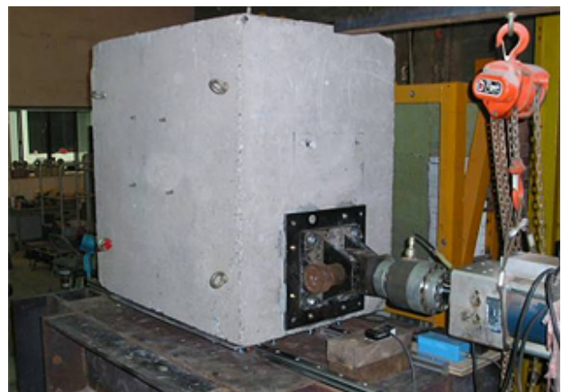
圖二、線性滑軌系統靜摩擦係數測試裝置
